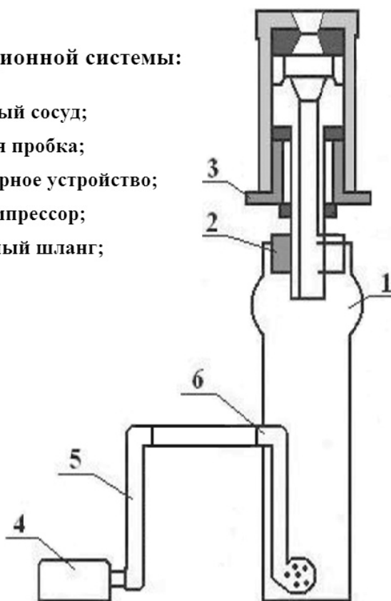
Рисунок 1 - Реакционная система для определения сероводорода с использованием РИБ
